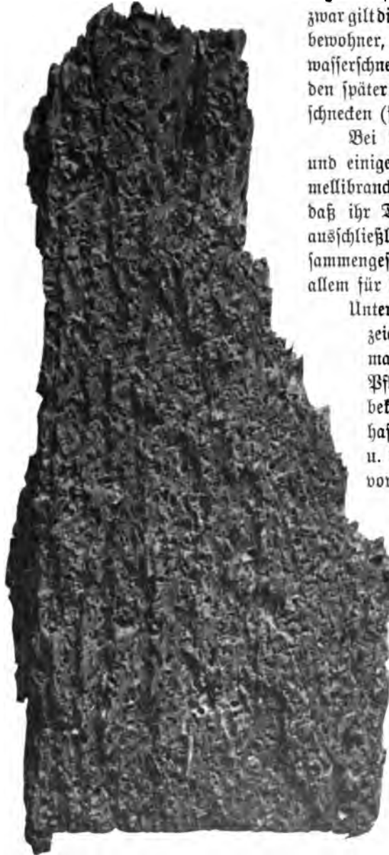
Abb. 11. Holz eines Hafenspihls mit den Bohrgängen der Affel Limnoria terebrans Leach. (Orig. Photographie.)
