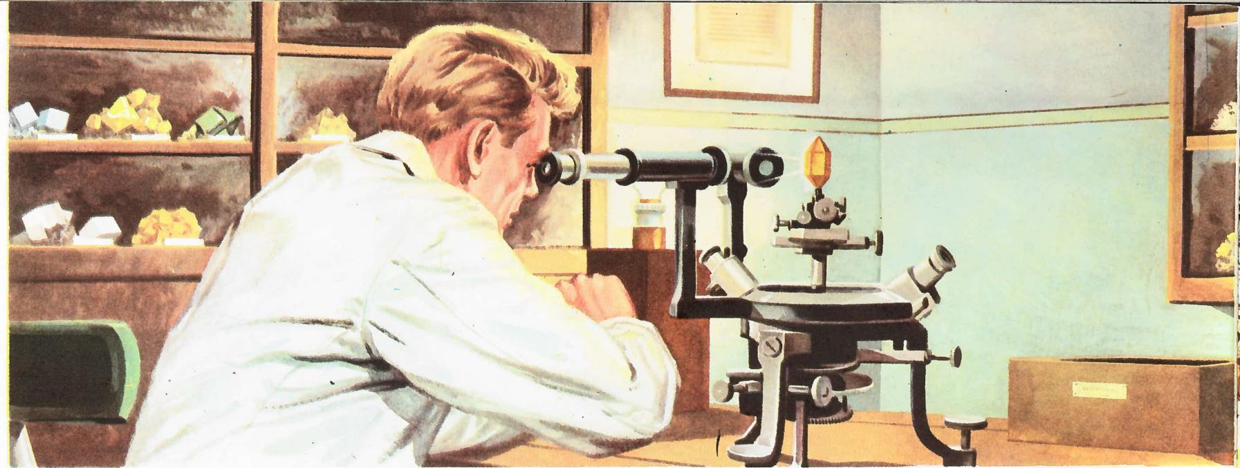
▲ إخصائى المعادن يستخدم جهاز قياس الزوايا إذا الانعكاس ، لقياس زوايا باللورة طبيعية . وهذا الجهاز يسمح بحساب درجة انحراف الشعاع الضوئي ، الذى تعكسه إحدى البلورات ، وبالتالي معرفة درجة انفراج الزوايا
