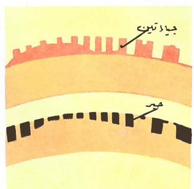
شكل مكبر لتفاصيل سطح الأسطوانة ، وبعها شفرة تقوم بتوزيع الحبر أو إزالة
