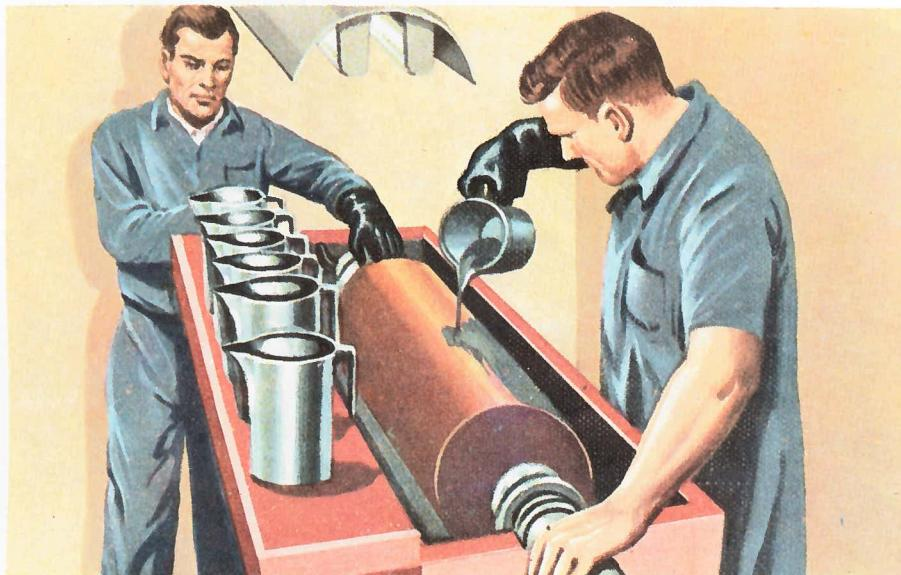
العامل يسكب حمضاً (كلوريد الحديديك) على أسطوانة النحاسية ، فيؤثر الحمض على سطحها ، متبعاً الخطوط الشبكية ما هي الآن النتيجة النهائية؟ .. هي أسطوانة تتخللها آلاف من الحفر الصغيرة ، تختلف في عمقها ، وتعطي طبعاً تفاوتاً شدته ، تبعاً لكتبة الحبر التي تحتوي عليها .
