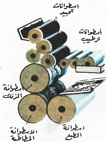
رسم توضيحي للطباعة بالأوفست ، وتقوم الأسطوانة التي تحمل لوح الزنك ، بعد تجبيتها ، بطبع الصورة على الأسطوانة المطاطية ، التي تقوم بدورها بطبع الورقة
