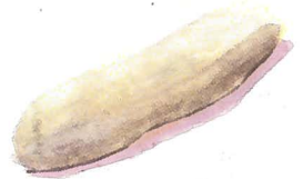
يصنع الصلصال على شكل عجينة لمدة طويلة حتى يكتسب تماسكاً متساوياً
