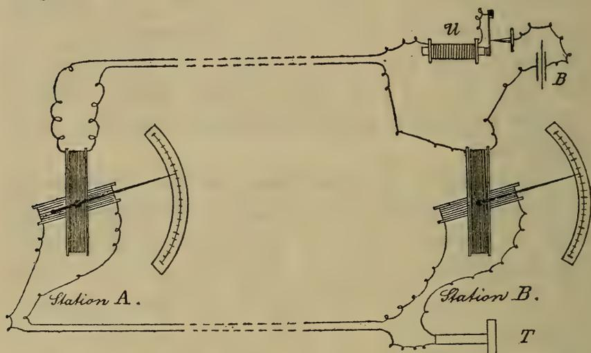
Auf der Station B, wo die Angaben des Messinstrumentes controllirt werden sollen, befindet sich ein ebensolches Rollensystem wie auf der ersten Station. Die grössere Spule ist wieder fest, die kleinere dagegen lässt sich leicht zugleich mit dem an ihrer Axe befindlichen Zeiger drehen. Zeiger, Skala und Spulensystem sind in Bezug auf Grösse und gegenseitige Lage genau den entsprechenden Theilen der Station A gleich.
